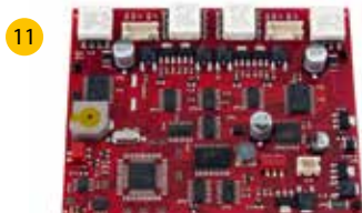
11 Mikroprozessoren sorgen für hohe Leistung und sparsamen Stromverbrauch
