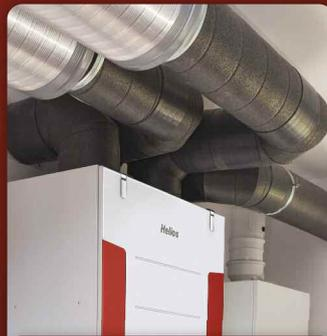
IsoPipe® ist die praktische Alternative zur Wickelfalzhrohr-Installation mit nachträglicher Wärmedämmung. Bereits fertig isoliert, eignet sich IsoPipe® ideal für die Außen- und Fortluftführung sowie für die Zu- und Abluftleitung im Keller- oder Kaltbereich. Das isolierte Rundrohrsystem verhindert Kondensatbildung und spart enorm an Montagezeit.
