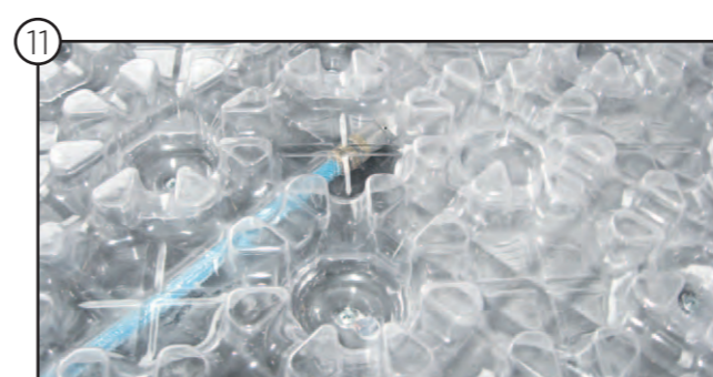
Pressluftdüse während der Reinigung
