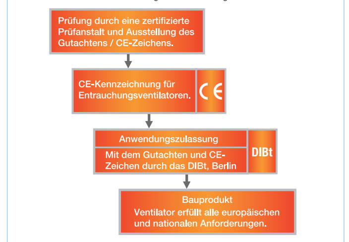
Bild 5 Bauaufsichtliche Anforderungen an Entrauchungsventilatoren
