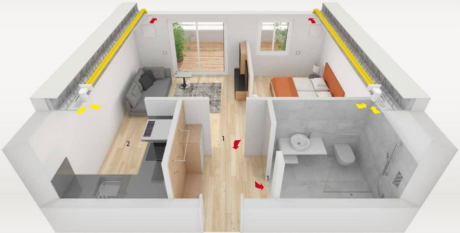
1 Bei den Innentüren müssen unverschießbare Überströmöffnungen zwischen Zu- und Abluftraum vorgesehen werden wie z.B. Türunterschnitt.
