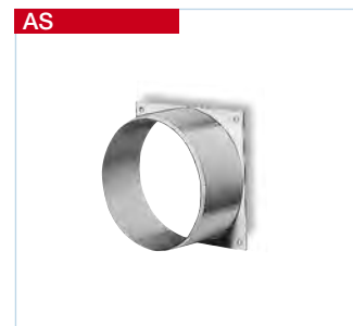
Type AS 100 Best.-Nr. 5224 Anschluss-Stutzen mit quadratischer Flanschplatte (102 x 102 mm) und rundem Stutzen (50 mm lang), aus Kunststoff. Zum Aufsetzen von Rohren (ND 100) auf plane Flächen.
